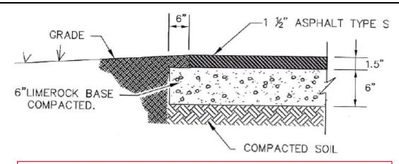
ASPHALT ONLY PERMITTED FOR COMMERCIAL DRIVEWAYS ABUTTING ALLEYS
